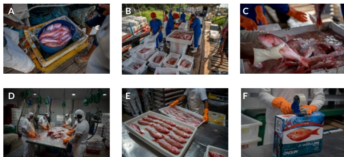
Figura 6. Fotografias das diferentes etapas da cadeia, desde (a) desembarque; (b) seleção no cais; (c) lavagem; (d) processamento; (e) congelamento e (f) embalagem para expedição.
